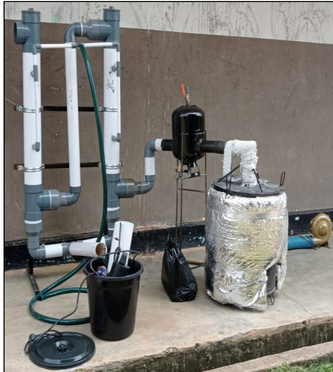
Gambar 4. Dokumentasi prototipe alat pembakar sampah bebas asap dan unit kondensasi yang digunakan pada kegiatan lapangan
