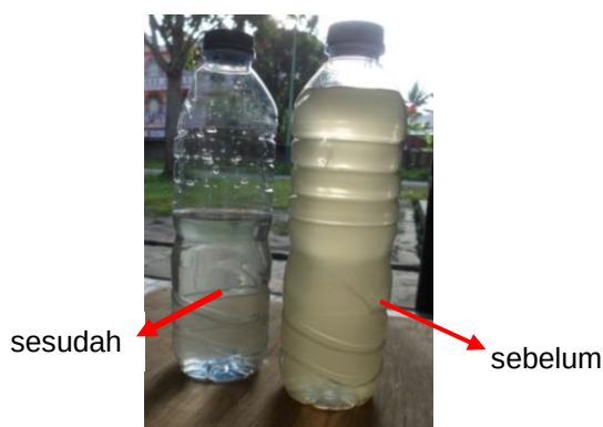
Gambar 10 Perbandingan warna Air Sesudah dan Sebelum Penyaringan
