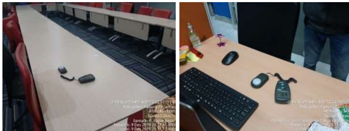
(a) Gambar 3. (a+b) Proses Pengukuran Intensitas Pencahayaan
